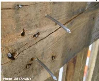
Lors du démontage d'une palette saisie sur le site de réparation, on constate que les pointes de fixation utilisées pour la réparation ne sont pas conformes.
